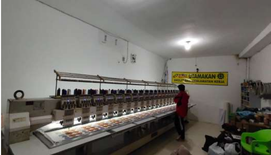
Proses Pengerjaan Bodir Menggunakan Mesin Komputer
