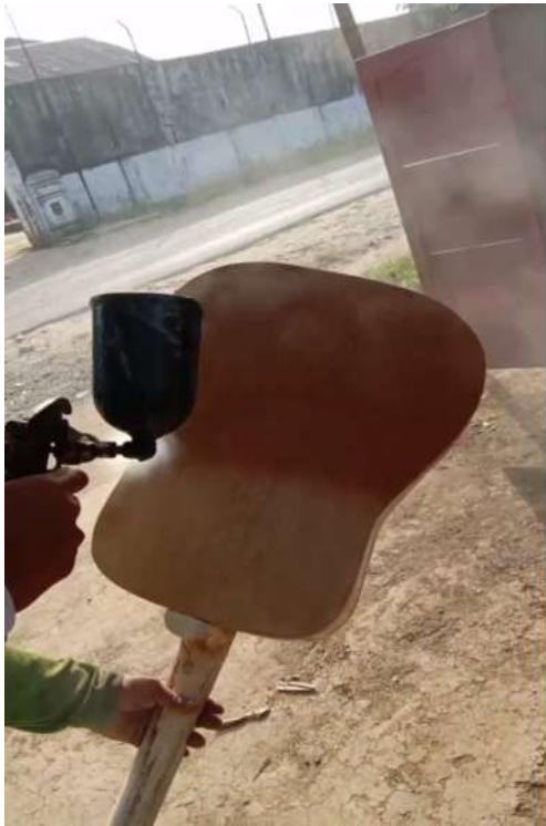
Gambar 20. Tahap penyemprotan sanding saller pada gitar
