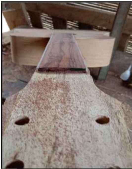
Gambar 15. Hasil Fingerbord gitar yang sudah dihaluskan
