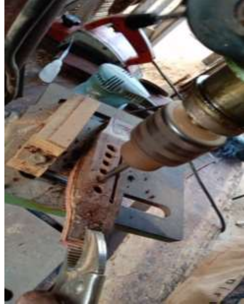
Gambar 18. Pelubangan pin bride gitar
