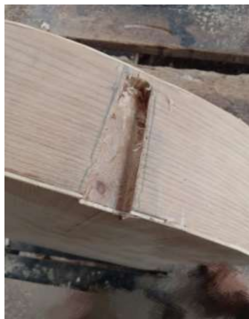
Gambar 10. Hasil tempat penyanggah neck gitar yang sudah dibentuk
