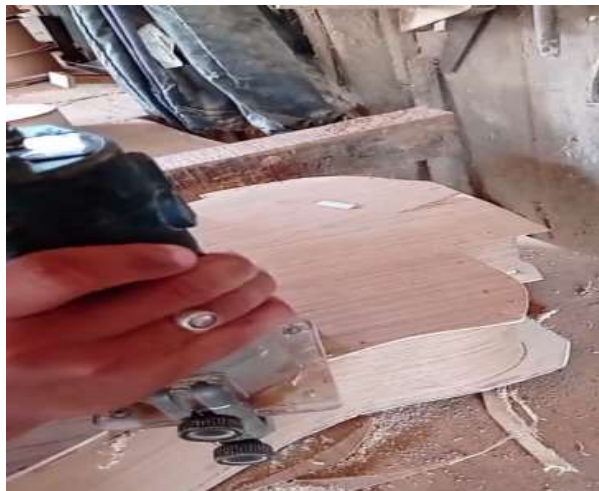
Gambar 7. Perapihan body gitar dengan alat potong profil
