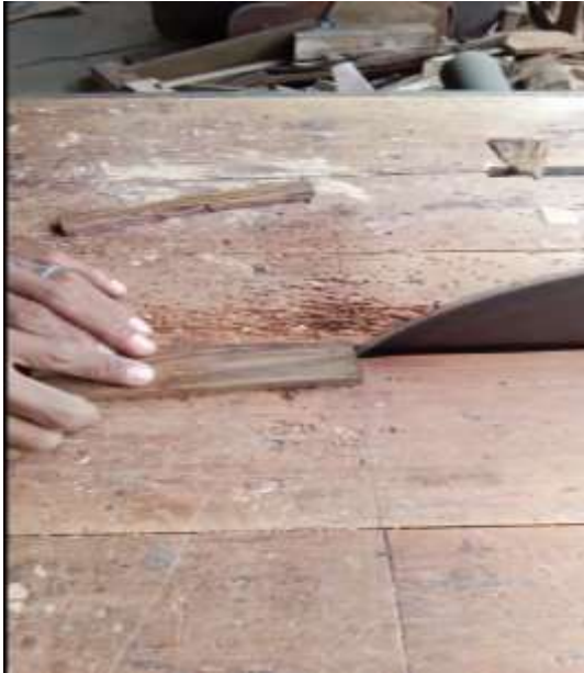
Gambar 17. Pembuatan bride gitar
