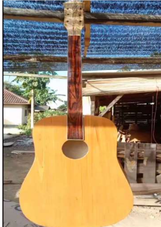
Gambar 21. Hasil gitar yang telah di sanding saller
