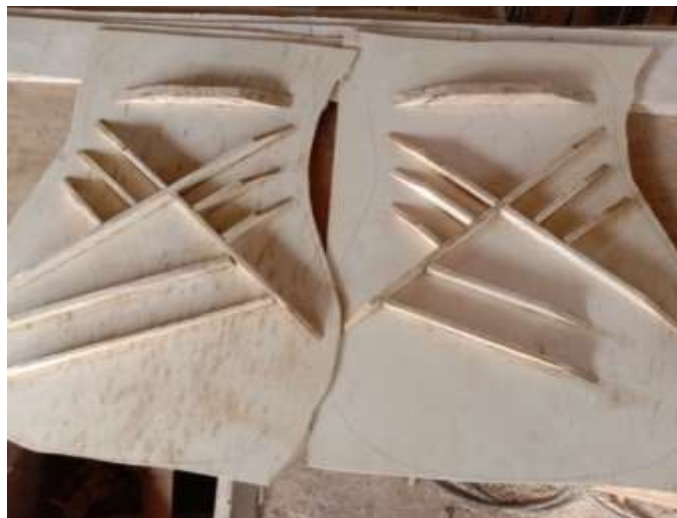
Gambar 2. Hasil Pemasangan bresing gitar
