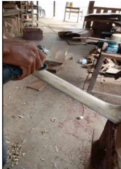
Gambar 16. Tahap penghalusan bawah neck gitar dengan alat grenda
