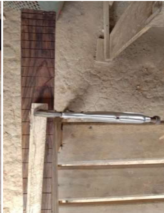
Gambar 13. Tahap pembuatan lubang fret gitar
