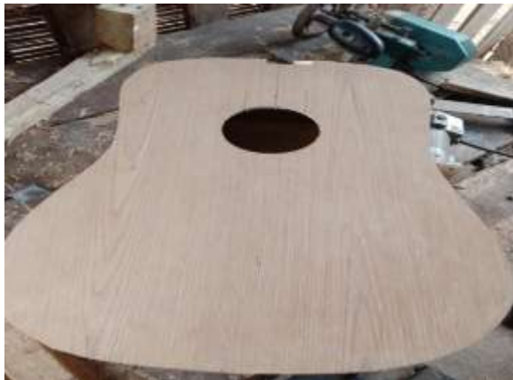
Gambar 8. Hasil body gitar yang sudah dirapihkan
