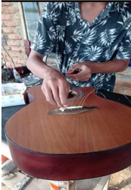
Gambar 27. Pemasangan pin dan senar gitar
