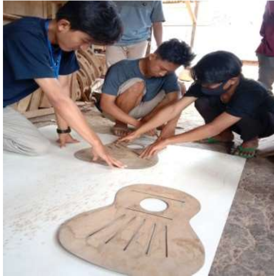
Gambar 1 Tahap mempola body gitar dan pemotongan
