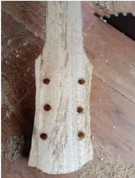
Gambar 12. Pembuatan Lubang Tunning
