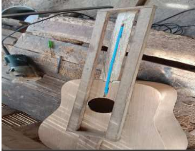
Gambar 14. Truss Rod Adjustemnt yang sudah dipasang
