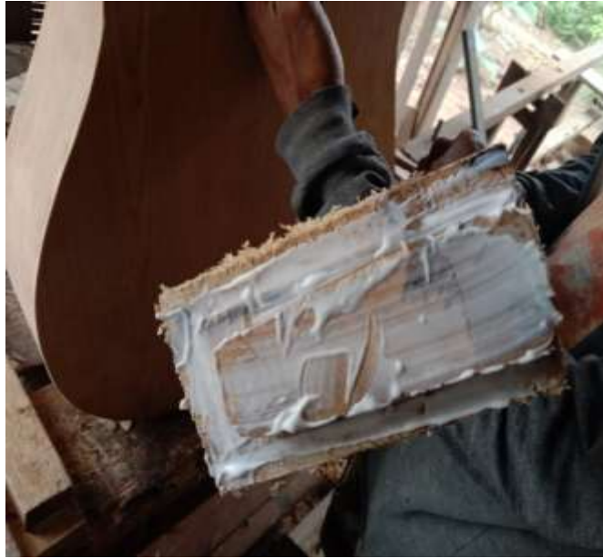
Gambar 11. Bagian bawah neck gitar yang diberikan lem
