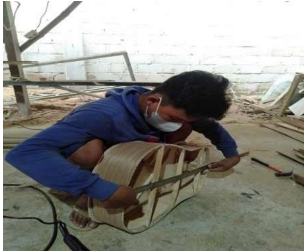
Gambar 5. Pemasangan bressing dengan penguat body
