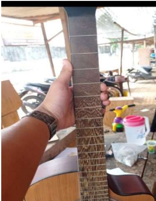
Gambar 25. Hasil pemasangan fret pada neck gitar
