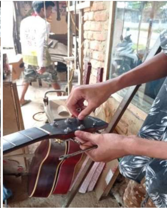
Gambar 26. Tahap pemasangan tuning pada head gitar
